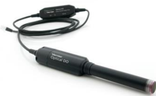
(ก) เซ็นเซอร์เชิงแสงวัดค่าปริมาณออกซิเจนละลายน้ำ
