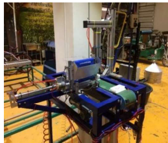
ภาพที่ 7 ต้นแบบระบบการควบคุมตำแหน่งการเสียบไม้เข้าวัตถุแบบกึ่งอัตโนมัติที่พัฒนาขึ้น
