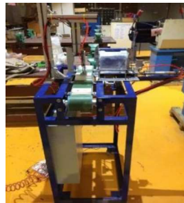
ภาพที่ 7 ต้นแบบระบบการควบคุมตำแหน่งการเสียบไม้เข้าวัตถุแบบกึ่งอัตโนมัติที่พัฒนาขึ้น
