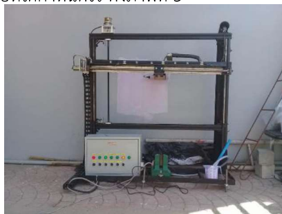
ภาพที่ 5 การทดสอบระบบควบคุมแขนกลทาสีผนังแบบอัตโนมัติ
