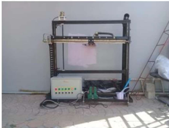
ภาพที่ 3 ระบบควบคุมแขนกลทำสีผนังแบบอัตโนมัติ
