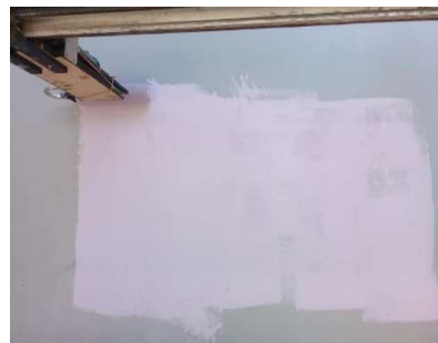
ภาพที่ 5 การทดสอบระบบควบคุมแขนกลทาสีผนังแบบอัตโนมัติ
